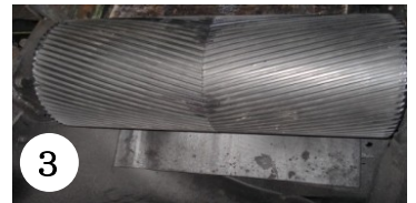
3. テールプーリー張替 ベルト交換して即使用する為、 現場にて接着。剥がれることはない。
