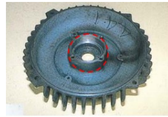
モーターケース・ベアリング部 内径耐摩耗溶射(寸法復元)
