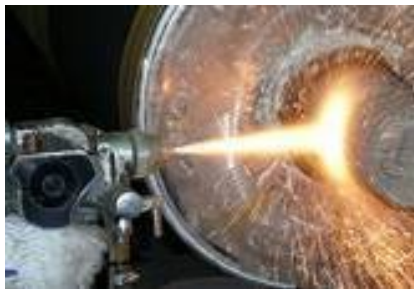
溶線式フレーム溶射(ワイヤー溶射法)
